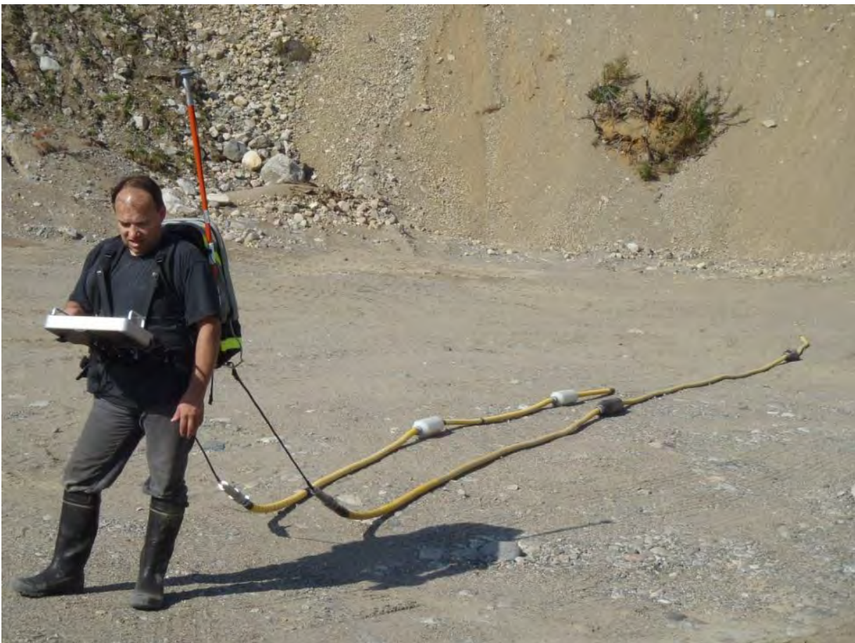
Kuva 5. Maatutkaluotausta käyttäen jalkaisin vedettävää Ramac ProEx –maatutkakalustoa ja suojaamattomia Rough Terrain letkuantenneja. Kuva A. Hyvönen, GTK.
